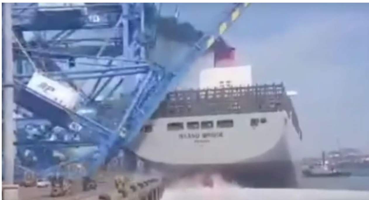
Рисунок 8 – Момент падіння берегового крану
