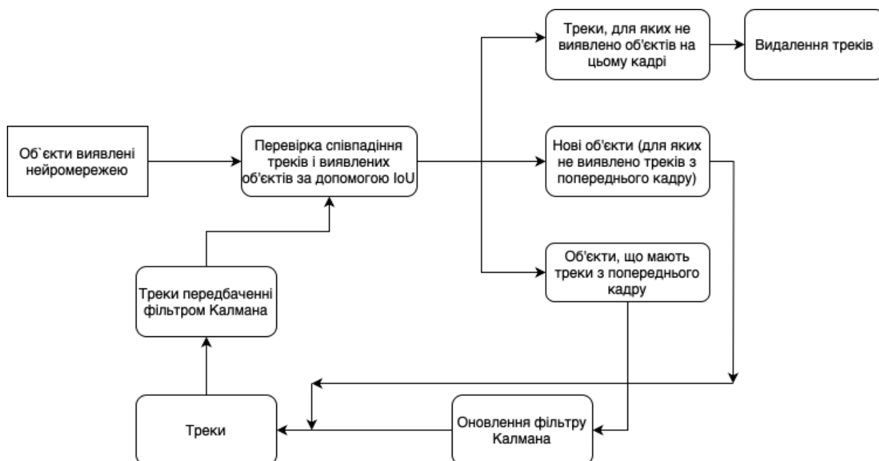
Рисунок 2 – Схема роботи алгоритму трекінгу об'єктів SORT
